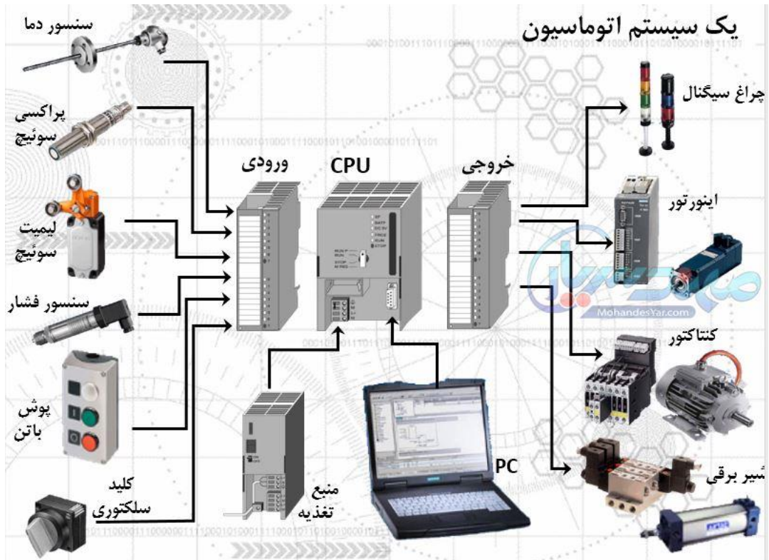
شکل 2 : ساختار و اجزا PLC
